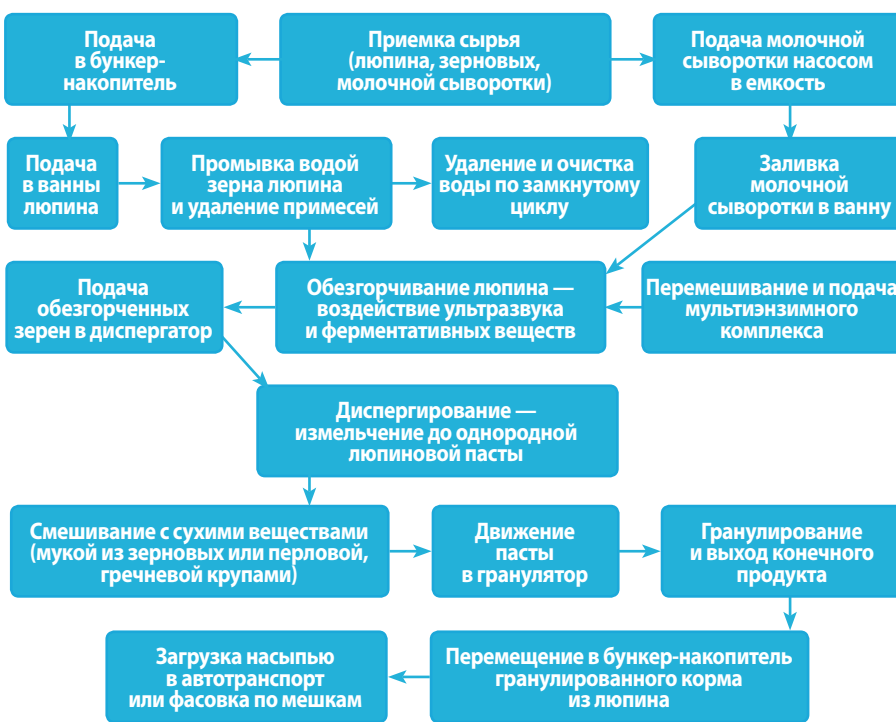
Рис. 2. Технологический процесс переработки люпина
